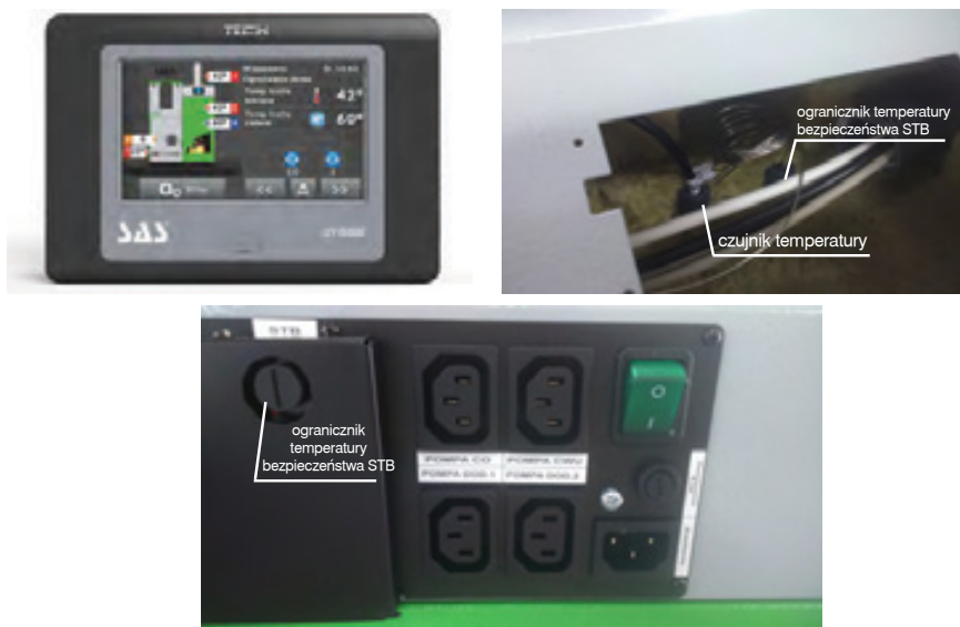
Rysunek 11 Lokalizacja ogranicznika temperatury bezpieczeństwa STB oraz czujnika temperatury
